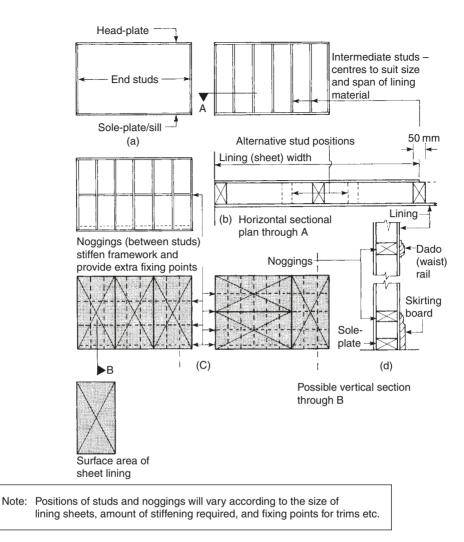
Fig. 9.2 Timber stud partitioning
